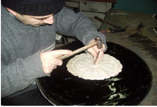
Görsel 8: Çelik Kalem ve Çekiçle Gümüş Metali Kabartma.
