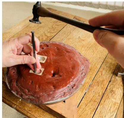
Görsel 6: Sarı (Prinç) Metal Üzerine Kabartma/Repousse Tekniği Uygulaması.
