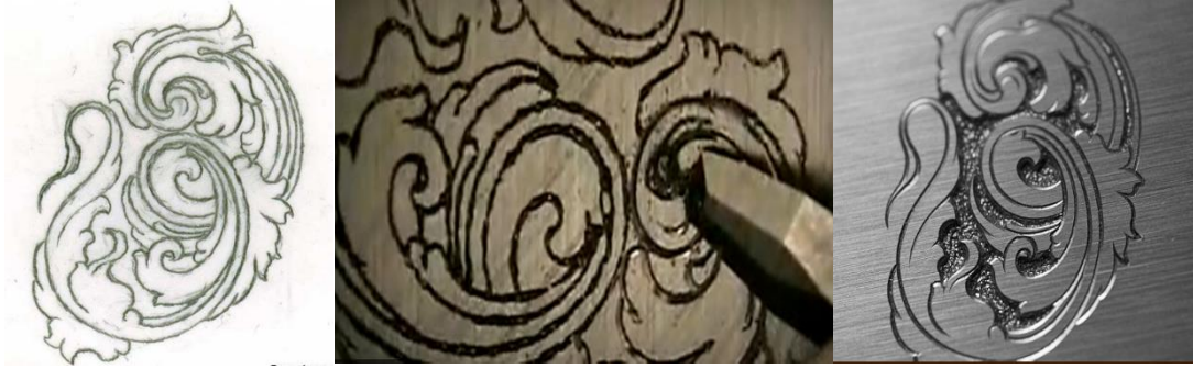
Görsel 2: Çelik Uçlu Kalemle Gümüş Metal Üzerine Kakma Tekniği Aşamaları.
