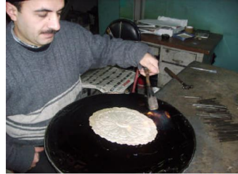
Görsel 9: Ziftin Isıtılıp, Yumuşatılarak Metalin Alınması.
