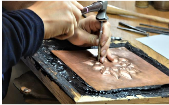
Görsel 3: Bakır Metal Üzerine Kabartma/Repousse Tekniği Uygulaması.
